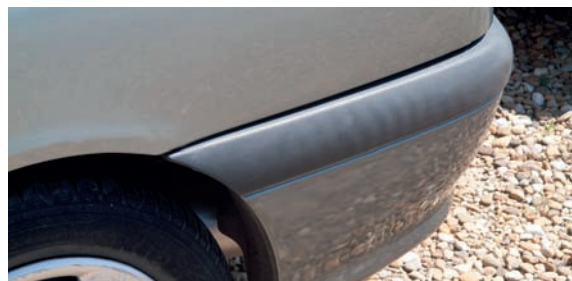
Plástico degradado por el sol.
