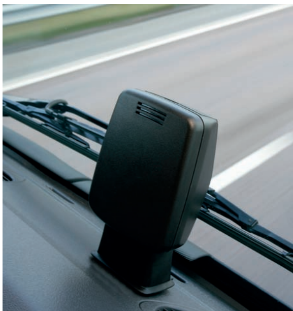
Mediante una cámara, el sistema LDW monitoriza el carril.
